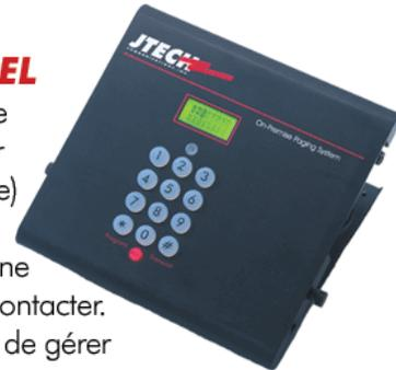
Fonctionnalité Téléphone : une fois branchée sur une prise analogique, il est possible d'envoyer un code à partir de tout téléphone. Pour ce faire il suffit de décrocher le téléphone, de taper le numéro de téléphone (interne) de la base, puis de saisir avec le clavier du téléphone, le numéro du bipeur suivi de la touche étoile puis le code à envoyer suivi de la touche dièse.
